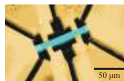
集束イオンビームで微細加工した PrMnSb 2 単結晶
