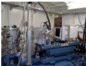
あいちSRの名古屋大学ビームラインに設置されている単結晶構造解析用回折計
